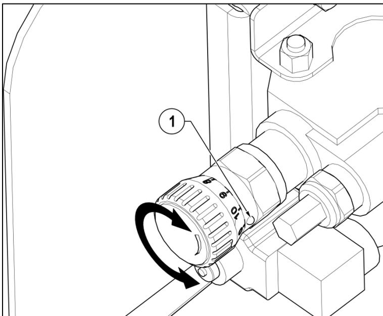
1 STEUERVERTIL - ANPASSEN DER EINZUGSGESCHWINDIGKEIT POSITION WIRD DURCH NASE ANGEZEIGT.
