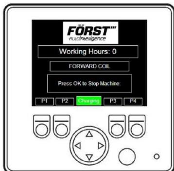
Falls der Motor nicht startet, den Schlüssel in die Aus-Position drehen und den Prozess erneut starten. P1 zeigt Betriebsstunden und Ladeanzeige unten mittig auf dem Bildschirm an.
