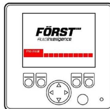
Zündschlüssel vollständig im Uhrzeigersinn drehen, um den Motor zu starten. Die Anzeige wechselt automatisch auf P1
