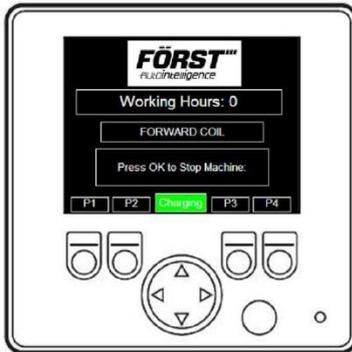
Falls der Motor nicht startet, den Schlüssel in die Aus-Position drehen und den Prozess erneut starten. P1 zeigt Betriebsstunden und Ladeanzeigetext unten mittig auf dem Bildschirm an.
