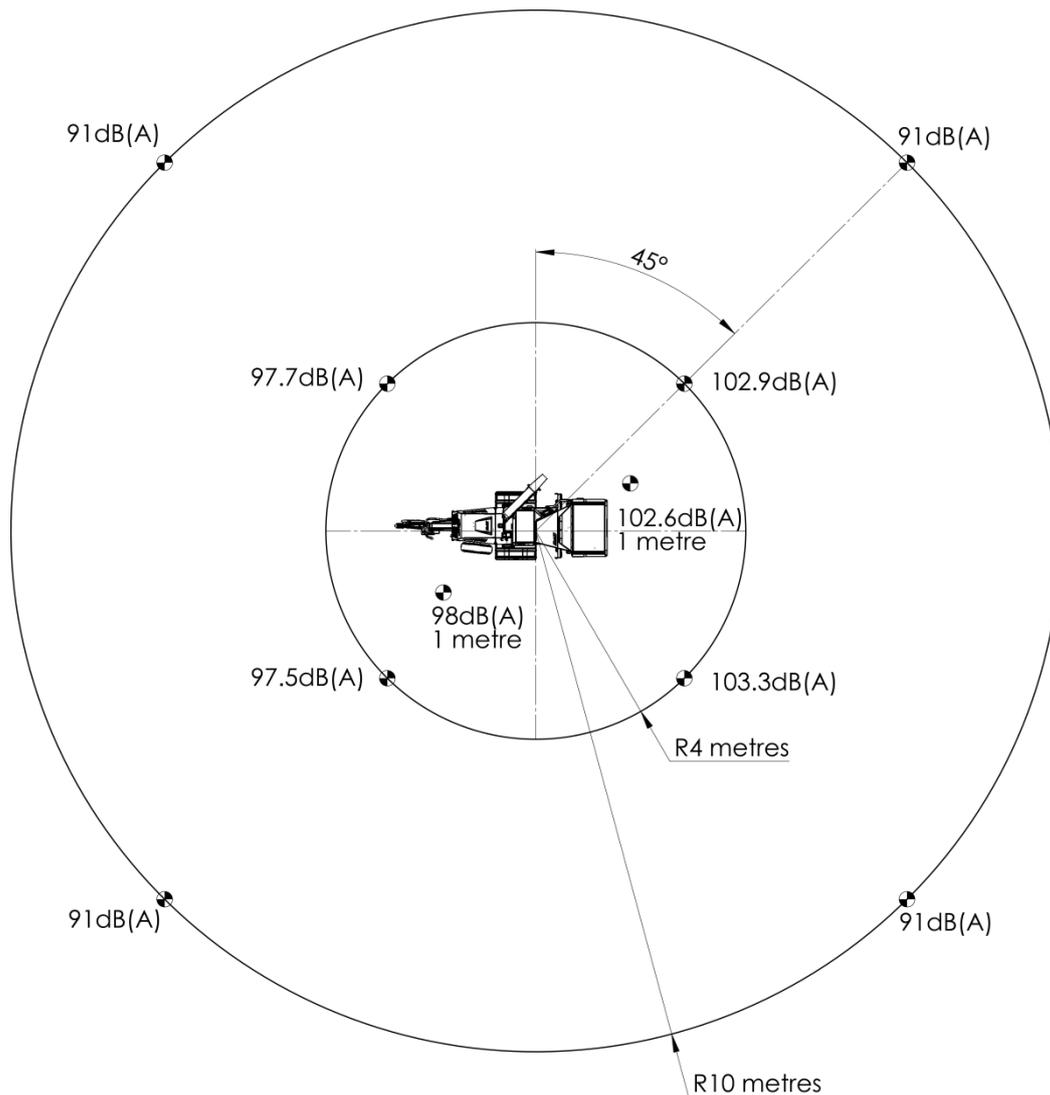
A-bewerteter Schalldruck (am Ohr des Bedieners)  $L_{pA} = 111,7$  dB (A). Momentaner C-bewerteter Emissionsschalldruckpegel (am Ohr des Bedieners)  $LC_{peak} = 136,7$  dB (C). Die Ergebnisse werden bei einem 10-Meter-Radius berechnet.
