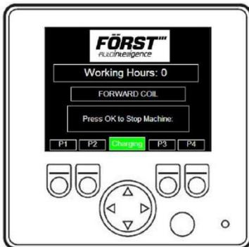
Falls der Motor nicht startet, den Schlüssel in die Aus-Position drehen und den Prozess erneut starten. P1 zeigt Betriebsstunden und Ladeanzeigttext unten mittig auf dem Bildschirm an.
