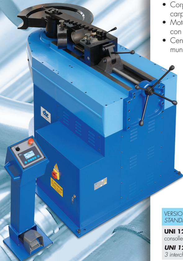
UNI 120, una curvatubi potente e precisa per curvare tubi di grande diametro. I raggi di curvatura ottimali non deformano in alcun modo i tubi curvati: ideale per le varie esigenze degli operatori nei settori dell'idraulica, nautica, oleodinamica, impiantistica in genere.
